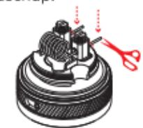
\*Zorg ervoor dat de spoelleidingen dicht bij elkaar zijn gesneden om kortsluiting te voorkomen. De spoelleidingen mogen de bel niet raken.
