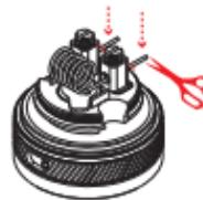
\*Stellen Sie sicher, dass die Spulenenden nahe abgeschnitten sind, um einen Kurzschluss zu verhindern. Die Spulenenden sollten nicht die Glocke berühren.
