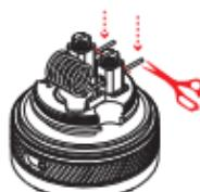
\*Certifique-se de cortar os fios da bobina firmemente para evitar um curto-circuito. Os fios da bobina não devem tocar na saída do vapor.
