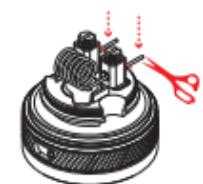
\*Asegúrate de que los extremos de la bobina estén recortados cerca para evitar un cortocircuito. Los extremos de la bobina no deben tocar la campana.
