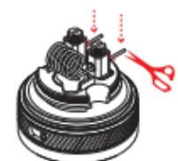
\*Assicurarsi che i conduttori della bobina siano tagliati vicini per evitare un cortocircuito. I conduttori della bobina non devono toccare la campana.
